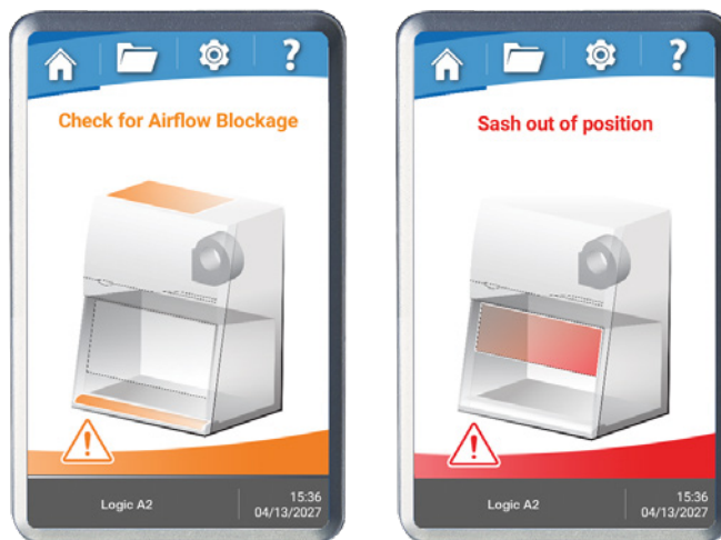
Sash Alarm display on Logic OS.
